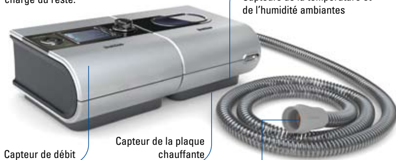
Capteur de la température au masque intégré au circuit chauffant ClimateLine
